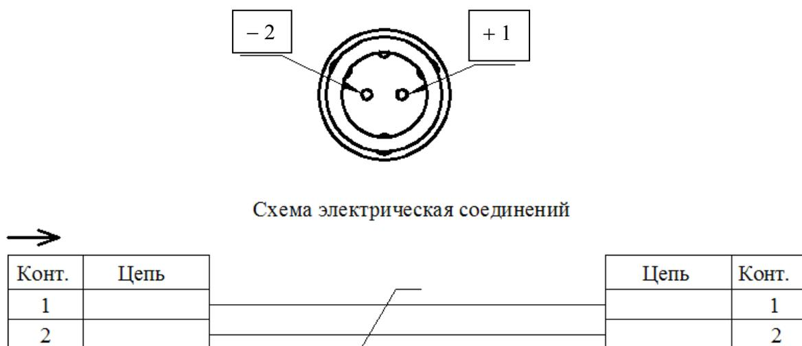
Рисунок 2 – Схема подключения разъема 4-20мА
